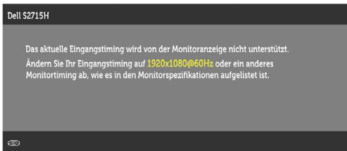
Das bedeutet, dass sich der Monitor mit dem vom Computer empfangenen Signal nicht synchronisieren kann. Siehe [Technische Daten des Monitors](#) für die horizontalen und vertikalen Frequenzbereiche, die für diesen Monitor adressierbar sind. Empfohlener Modus ist 1920 x 1080.
